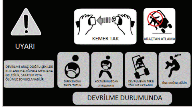
Görsel 3.42: Forklift devrilmesi durumunda yapılacaklar
