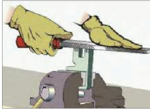
Görsel 3.23: Mengene ve kısıkaçların kullanımı
